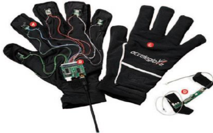
Figure 3.3: MIT Aceleglove with multiple sensors [73].
