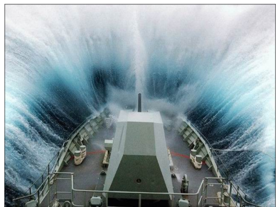
(d) Green-water on deck slamming
